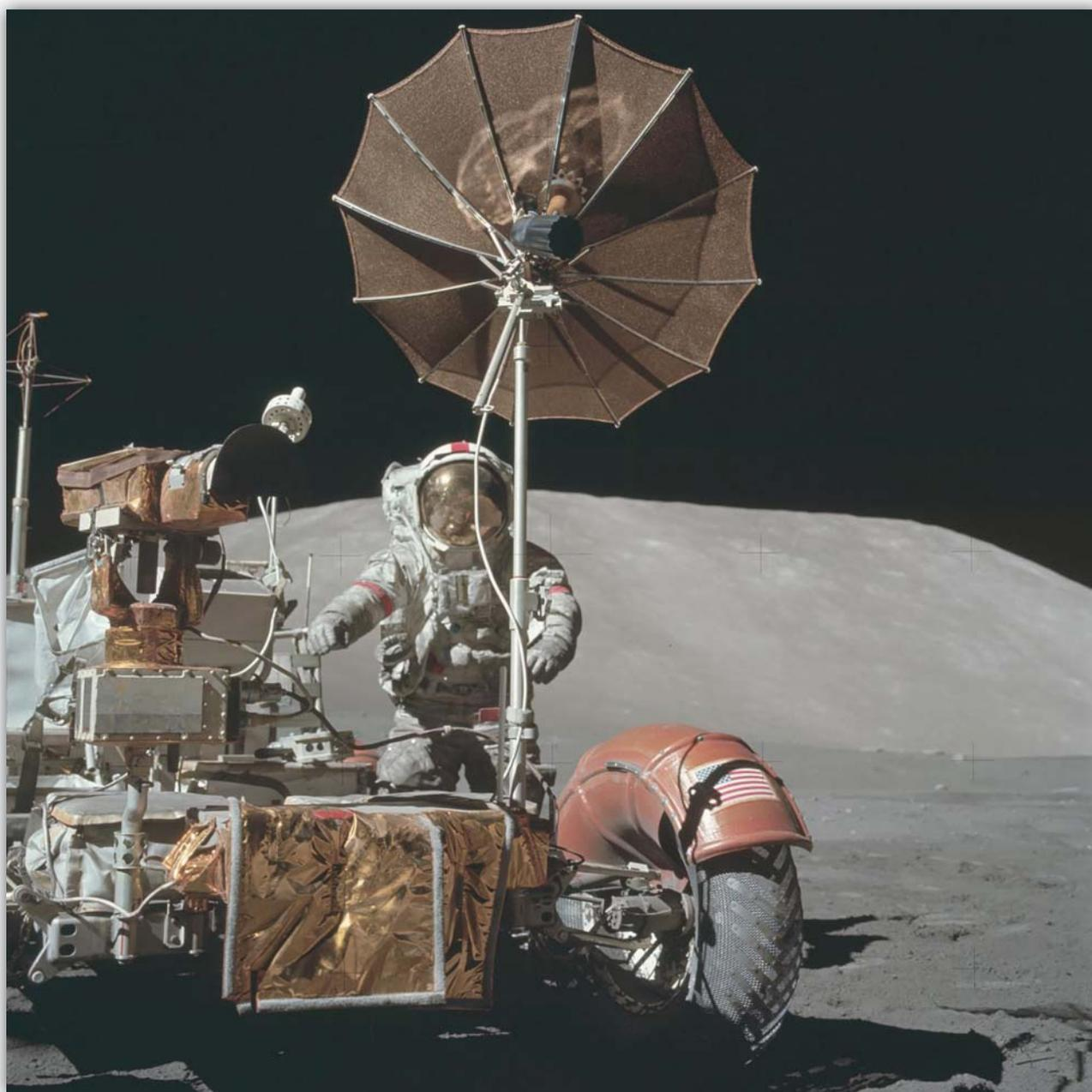
Figura 8.18-1. Al centro in alto, l'antenna parabolica del Rover di Apollo 17. La telecamera telecomandata è sulla sinistra. Foto AS17-134-20475.
