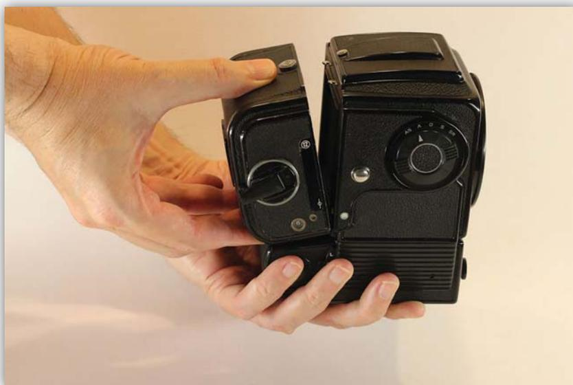
*Figura 8.9-1. Innesto di un caricatore sul corpo di una fotocamera Hasselblad EL/M simile a quelle usate sulla Luna. I caricatori lunari erano più grandi di quello mostrato qui. Credit: PA.*
