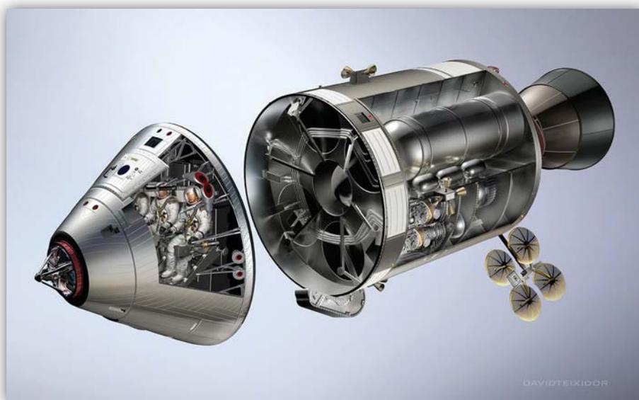
Figura 2.2-1. A sinistra, il modulo di comando Apollo; a destra, il modulo di servizio. Credit: DavidTeixidor.
