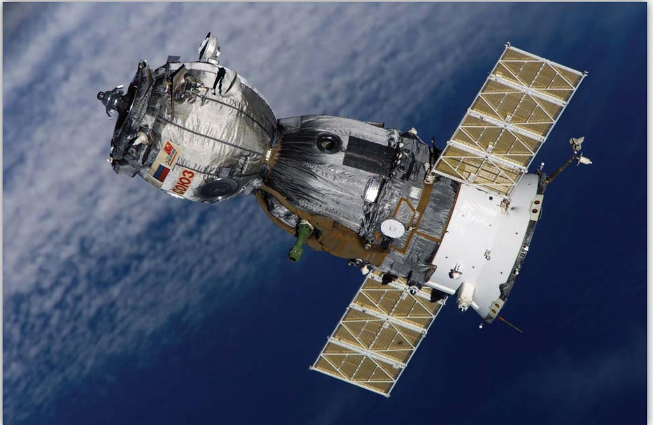
Figura 7.17-5. Un veicolo russo Soyuz (TMA-7) fotografato nello spazio poco dopo il distacco dalla Stazione Spaziale Internazionale mostra la coperta termica che lo riveste. Foto NASA ISS012-E-24219, 8 aprile 2006.
