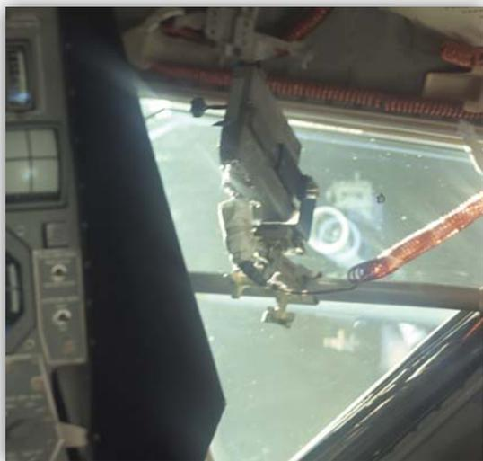
*Figura 6.1-3. La cinepresa Maurer in posizione prima dello sbarco sulla Luna dell'Apollo 11. Dettaglio della foto AS11-36-5389.*
