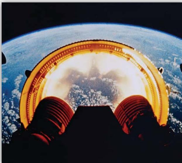
Figura 7.15-2. Apollo 6: separazione dell'anello fra i primi due stadi del Saturn V. Fotogramma ripreso da una delle cineprese automatiche di bordo.
