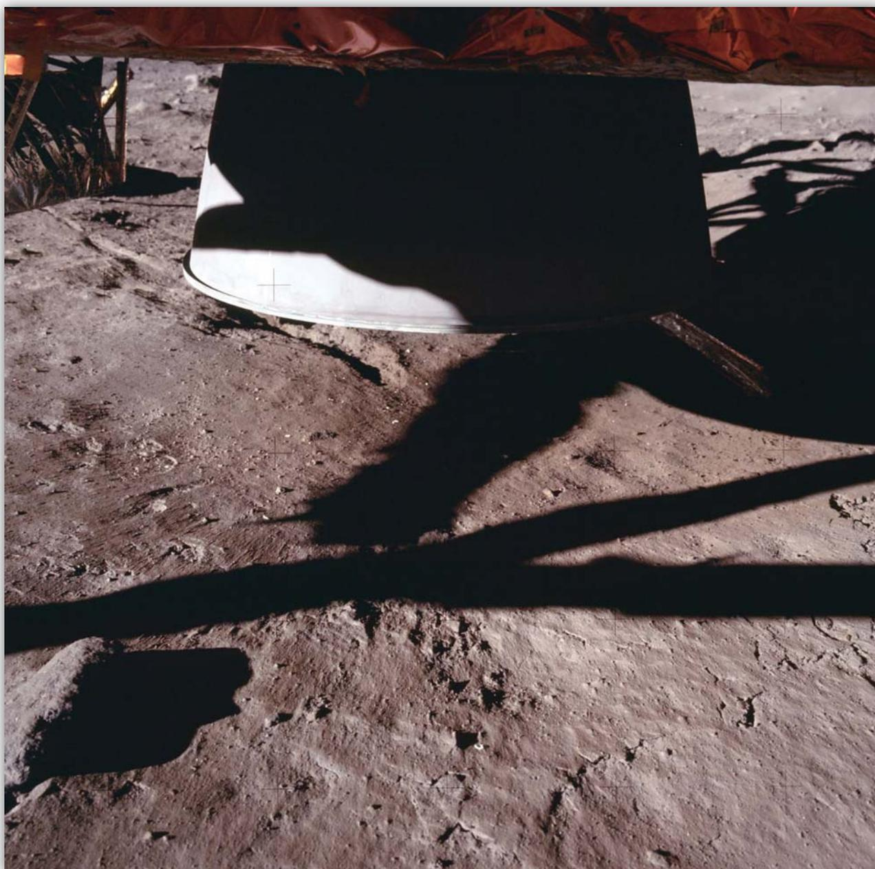
*Figura 8.11-4. L'ugello del motore di discesa del modulo lunare dell'Apollo 11. Si notano in primo piano la superficie rocciosa liscia e priva di polvere e i segni a raggiera prodotti dal getto del motore. Foto AS11-40-5921.*
