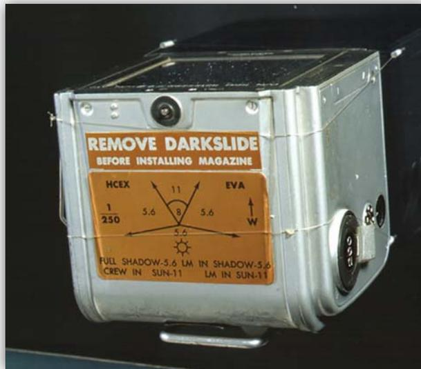
Figura 5.1-6. Un caricatore di pellicola usato per la missione Apollo 11. Si nota l'adesivo recante il promemoria delle regolazioni per le varie condizioni di luce.
