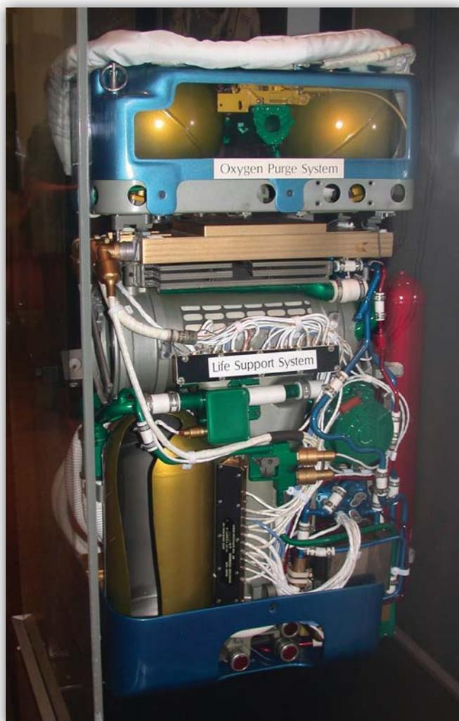
Figura 8.10-3. L'interno di uno zaino delle tute spaziali Apollo (visto da dietro).
