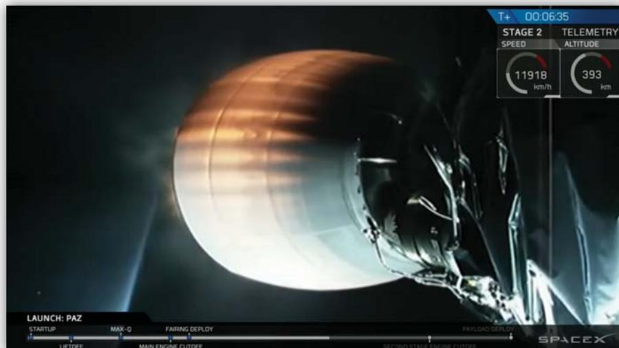
Figura 6.12-5. Il motore del secondo stadio del vettore Falcon 9 di SpaceX è acceso, come si nota dal fatto che l'ugello è incandescente, ma non emette una fiammata estesa nell'atmosfera estremamente rarefatta che si incontra a 393 km di quota dalla Terra. Fonte: diretta SpaceX.
