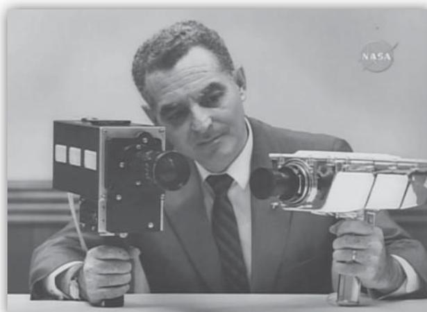
Figura 6.1-5. Stan Lebar, capo del progetto delle telecamere Apollo della Westinghouse, mostra la telecamera per interni (a sinistra) e quella lunare (a destra) dell'Apollo 11.
