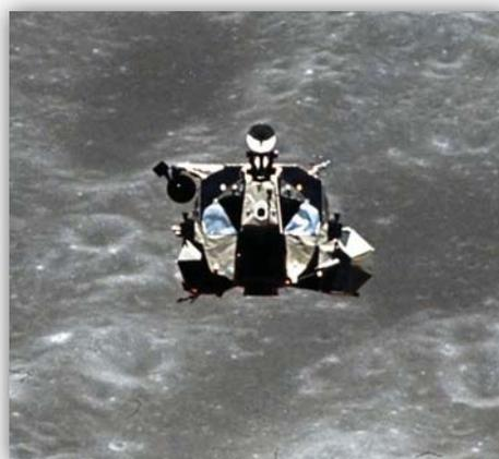
Figura 7.11-1. Lo stadio di risalita del Modulo Lunare di Apollo 16 torna dalla Luna. Dettaglio della foto AS16-122-19530.
