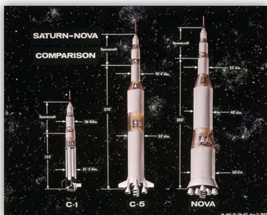
Figura 7.5-2. A destra, il Nova versione 8L; al centro, il C-5, precursore del Saturn V. Documento M-MS-G-36-62, aprile 1962.
