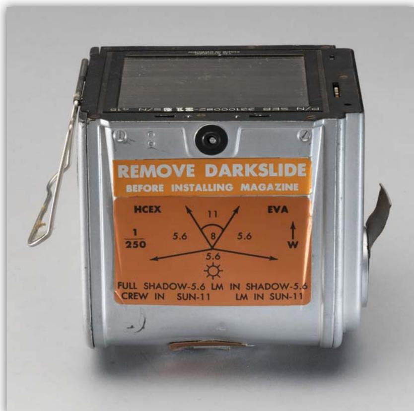
Figura 16.6-2. Caricatore di fotocamera Hasselblad con le indicazioni delle impostazioni per le foto nelle varie condizioni di luce sulla Luna.
