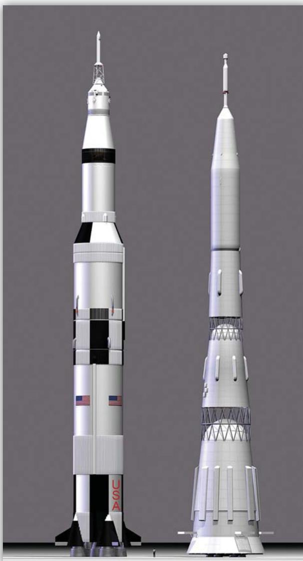
Figura 7.2-1. Confronto dimensionale fra Saturn V-Apollo (a sinistra) e vettore N1-L3 (a destra). La persona in basso è in scala.
