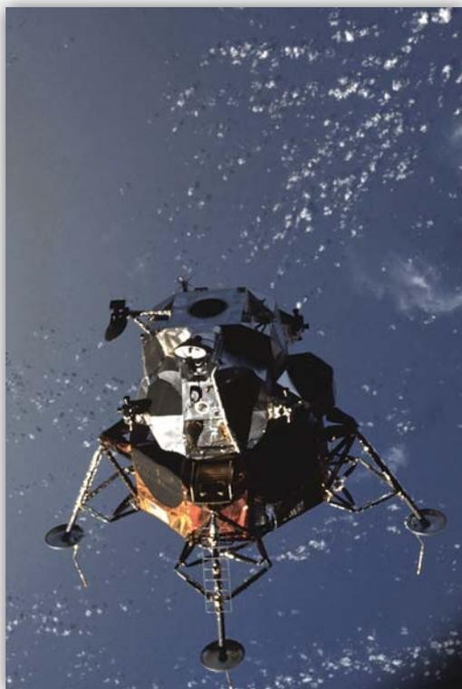
*Figura 10.4-1. Cosa ci fa un modulo lunare in orbita intorno alla Terra? Semplice: è il suo collaudo effettuato durante la missione Apollo 9. Dettaglio della foto AS09-21-3183.*
