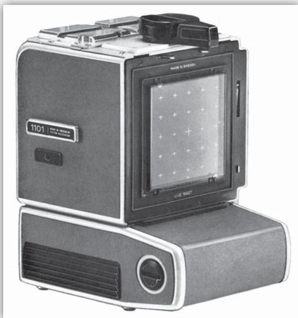
Figura 5.14-1. Le crocette di riferimento sul vetrino di una fotocamera Hasselblad. Il caricatore di pellicola, qui rimosso per chiarezza, si aggancia a ridosso del vetrino.
