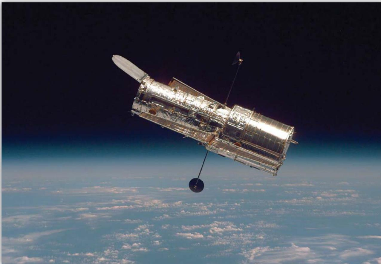
Figura 7.6-1. Il telescopio spaziale Hubble, fotografato dallo spazio nel 1997 durante la missione Shuttle STS-82 (Discovery), ha uno specchio primario da 2,4 metri di diametro. Fonte: NASA.
