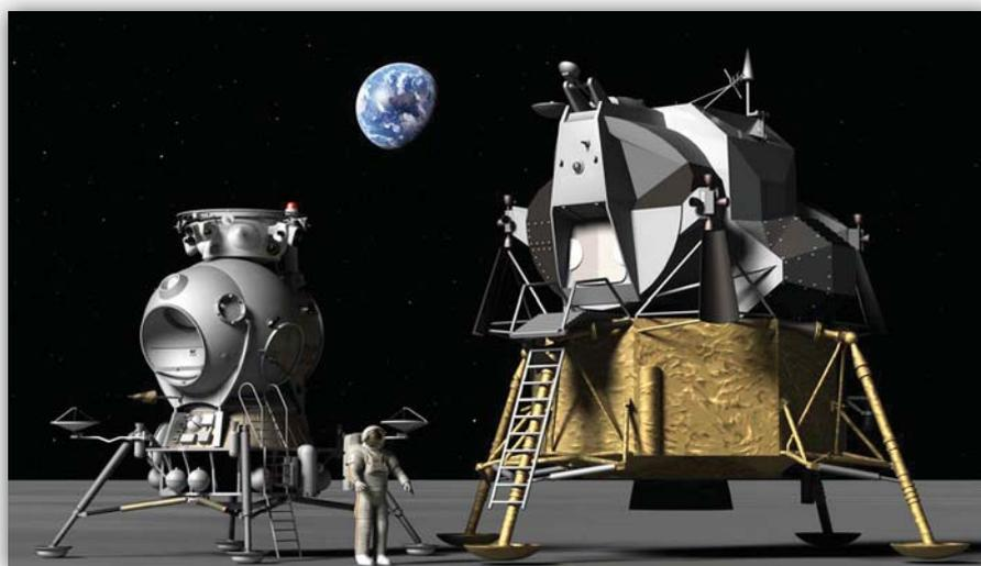
Figura 1.6-3. Confronto in scala fra il veicolo di allunaggio sovietico (a sinistra) e quello statunitense (a destra).
