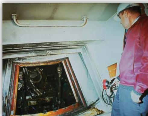
Figura 9.9-2. Il vano del portello di Apollo 1 mostra l'interno carbonizzato della capsula.
