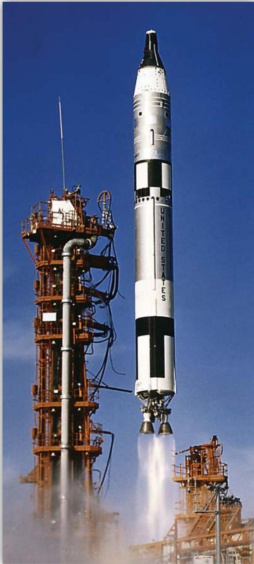
*Figura 6.12-6. Decollo del vettore Titan che l'11 novembre 1966 porta in orbita la capsula Gemini 12. Si notano lo scarico dei motori pressoché incolore e l'assenza di fiamme.*
