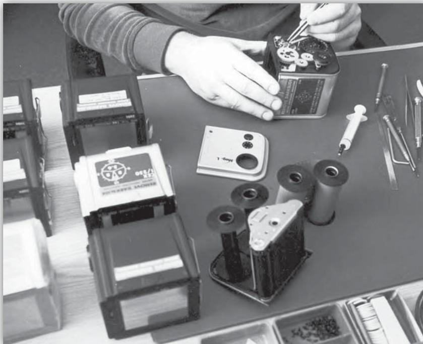
Figura 5.1-5. Un tecnico della Hasselblad prepara un caricatore di pellicola per le missioni Apollo. In primo piano si nota il meccanismo di supporto della pellicola su due rulli. Foto C-81-4. Fonte: ALSJ/Ulli Lotzmann.
